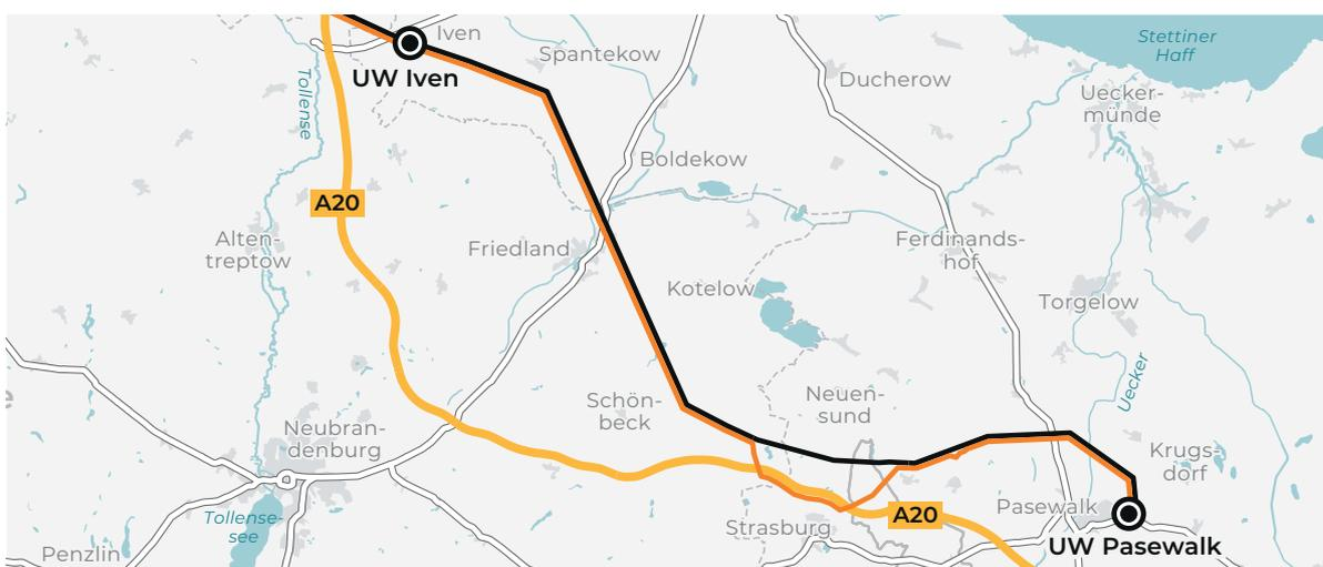
Die schwarze Linie zeigt den Verlauf der bestehenden 220-kV-Leitung. Die orange Linie zeigt den geplanten Trassenverlauf für die neue 380-kV-Leitung.
